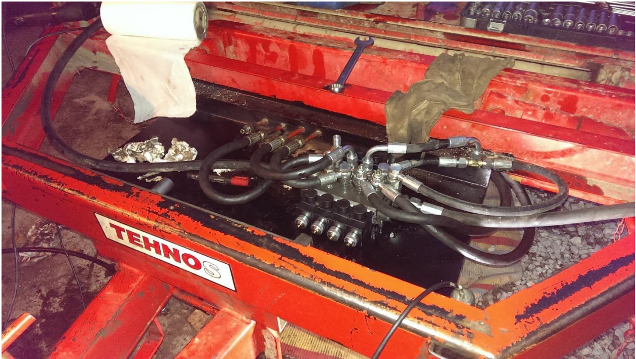
Slika 15: Skoraj dokončana hidravlična napeljava
