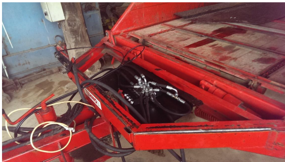
Slika 10: Nedokončana hidravlična napeljava
