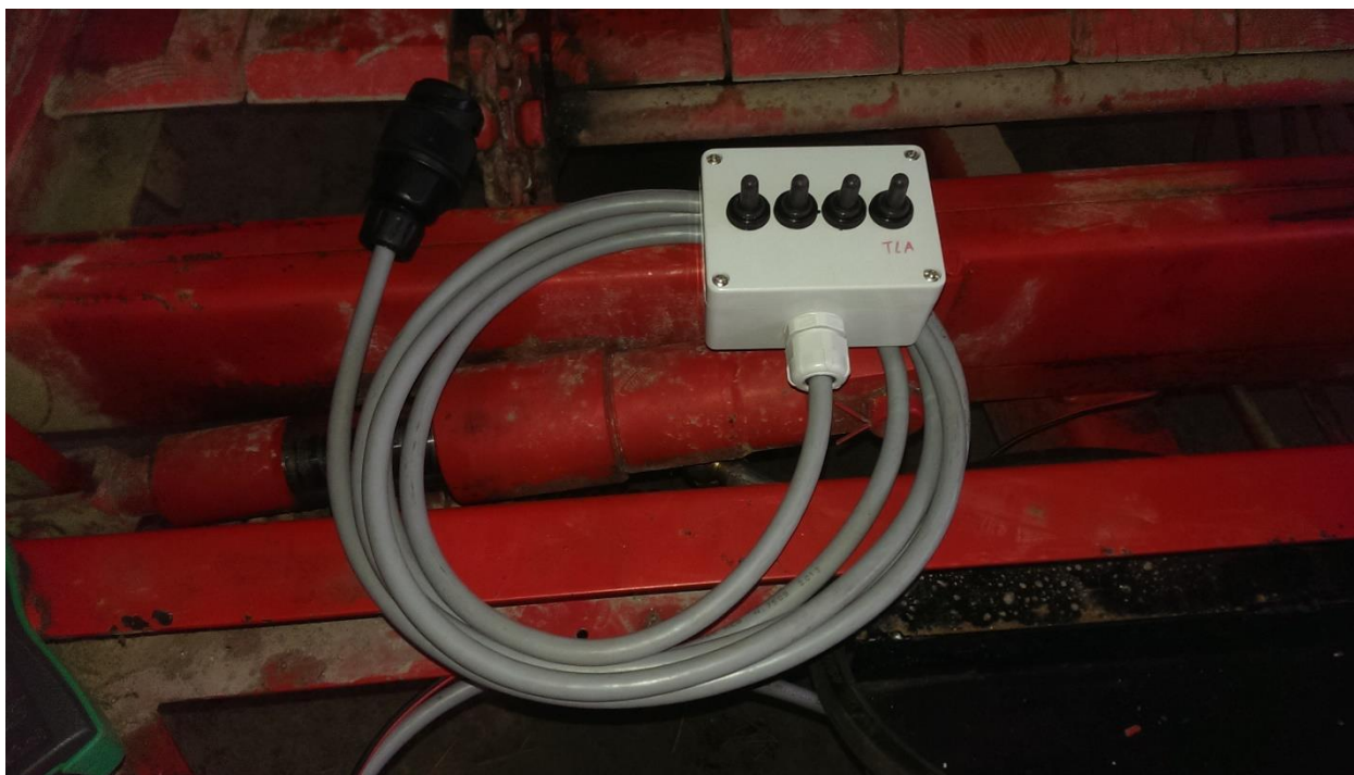
Slika 17: Kabelske komande z moškim konektorjem
