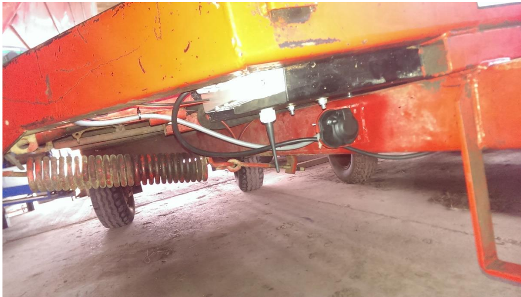
Slika 18: Ženski konektor pod omarico in antena
