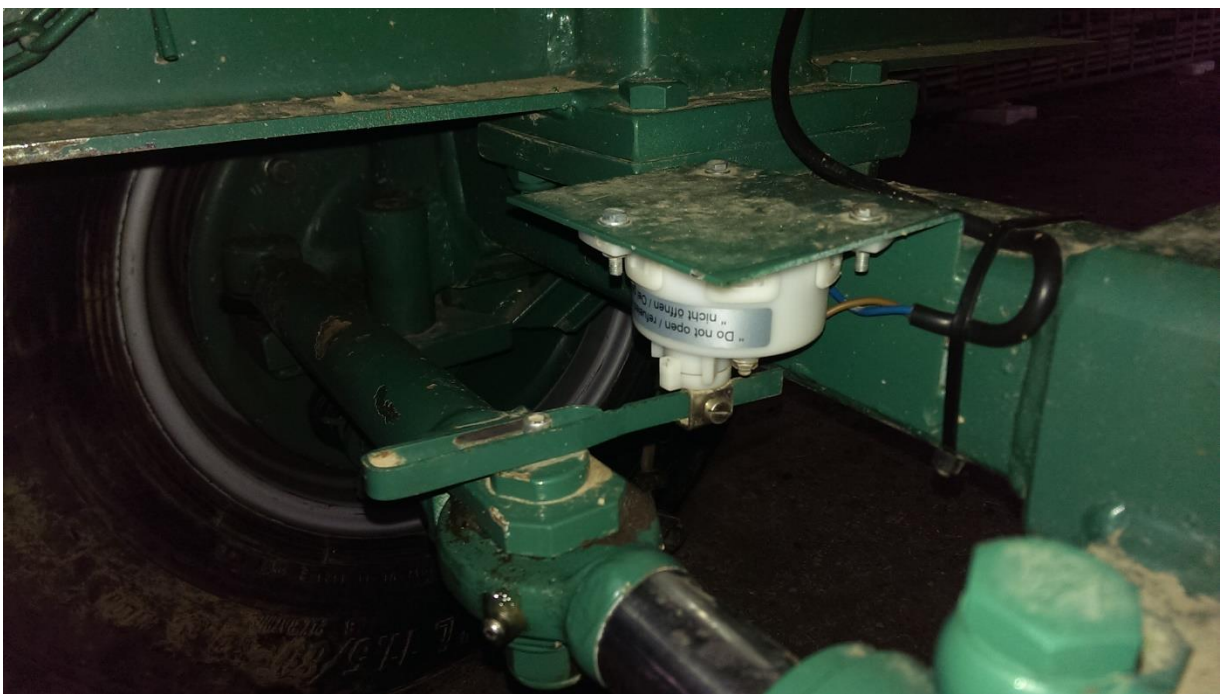
Slika 23: Nameščen senzor na osi prikolice
