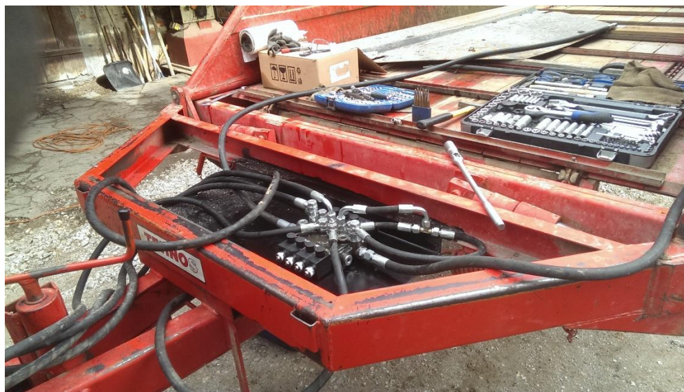
Slika 14: Pritrjeni ventili na ploščo
