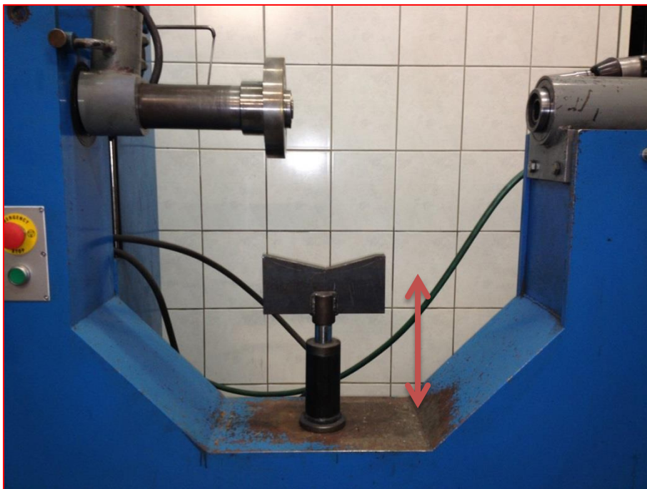
Slika 19: Prikaz smeri delovanja cilindrov
