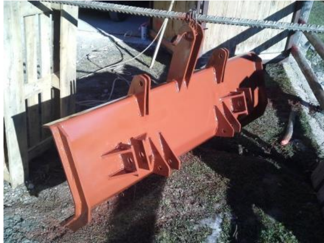
Slika 29: Deska prebarvana s temeljno barvo
