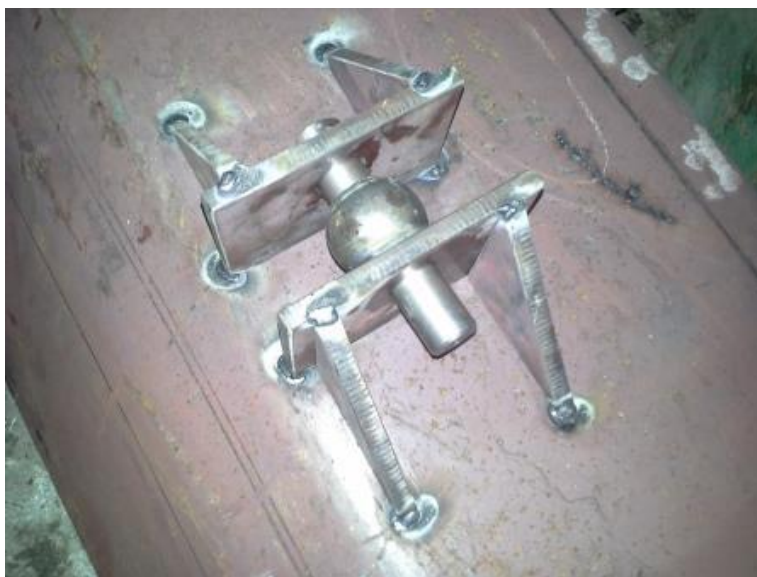
Slika 19: Točkovno zvarjeno vpetje
