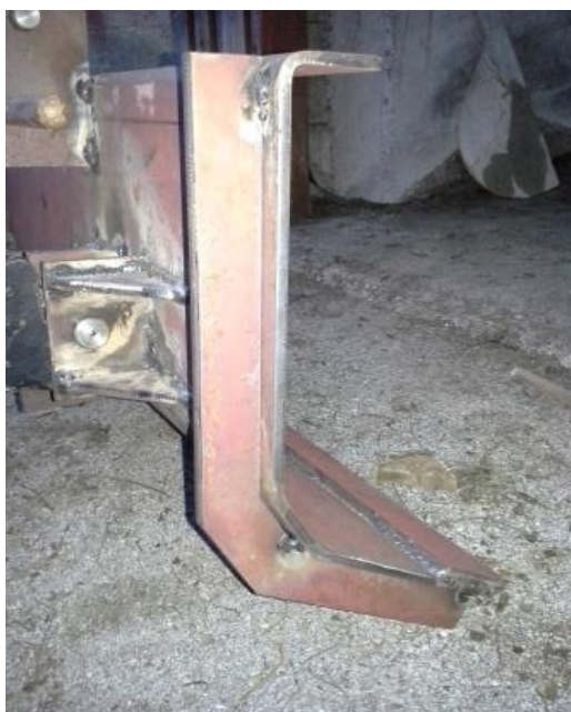
Slika 21: Točkovno zvarjeno rezilo
