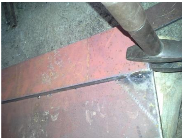
Slika 21: Točkovno zvarjeno rezilo
