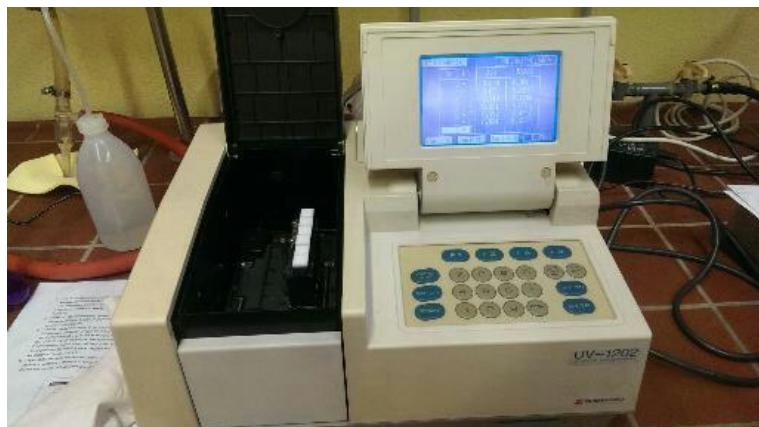
Slika 22: Spektrofotometer SHIMADZU UV – 1201
