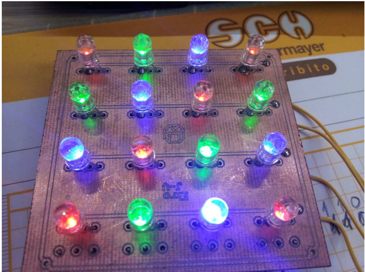
Slika 27: Prvi prikaz barv na RGB 4x4 prikazovalniku
