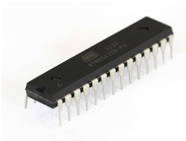
Slika 6: ATmega328 mikročip proizvajalca ATMEL
