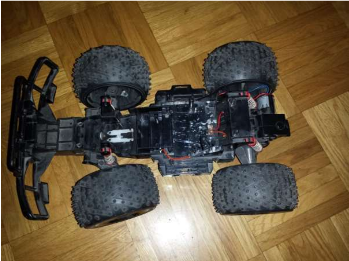
Slika 10: Slika popravljenega ogrodja brez gredi in z še vgrajenim motorjem
