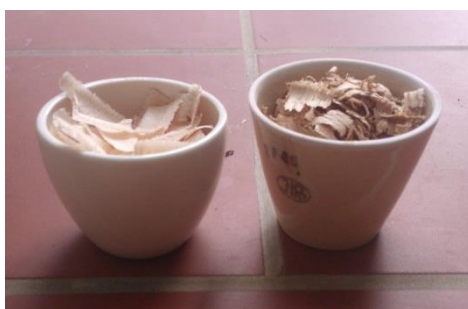
Slika 7: Žarilna lončka, polna z drevesnimi ostružki (levo – bukev, desno – hrast), pred žarjenjem.
