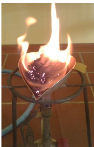
Slika 11: Žganje ostružkov iz bukovega lesa v digestoriju.
