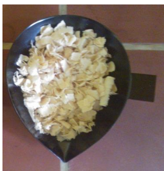
Slika 10: Žarilna posoda, polna ostružkov iz bukovega lesa, pred žganjem.
