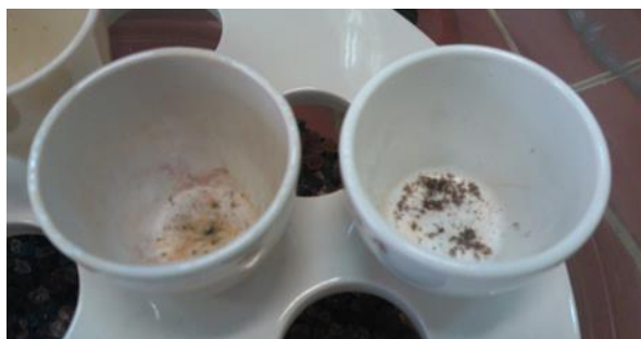
Slika 9: Žarilna lončka, po žarjenju z anorganskimi ostanki (levo – bukev, desno – hrast) v eksikatorju.
