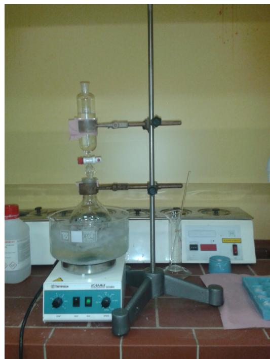
Slika 7: Naprava za sintezo grafenovega oksida
