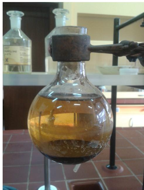
Slika 9: Bučka s suspenzijo grafenovega oksida in kisline
