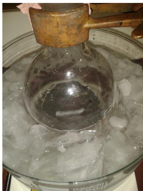
Slika 8 Bučka z grafitom in kalijevim permanganatom
