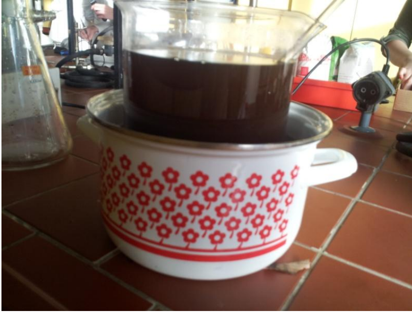
Slika 11: Encimska pretvorba v termostatski kopeli
