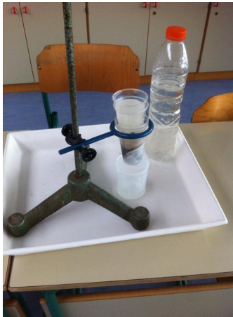
Fotografija 28. Filtracija vode s potoka v prvem prečiščevalnem stebru.
