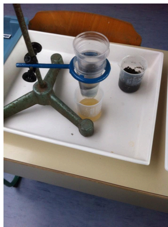
Fotografija 32. Filtracija zemlje in vode v tretjem prečiščevalnem stebru.
