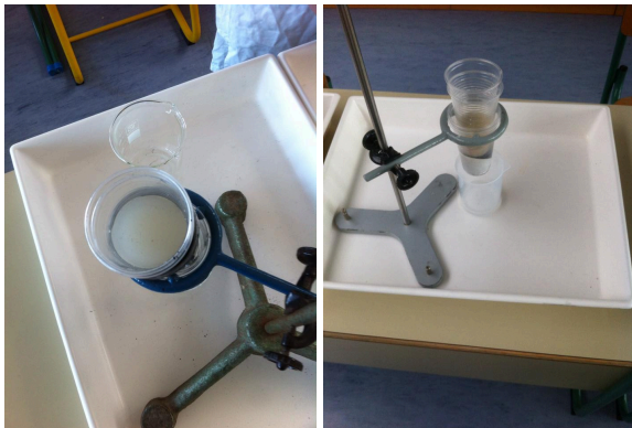
Fotografija 26. Aktivno oglje v prahu ni primerno za filtracijo vode, zato smo uporabili aktivno oglje v večjih delcih.
