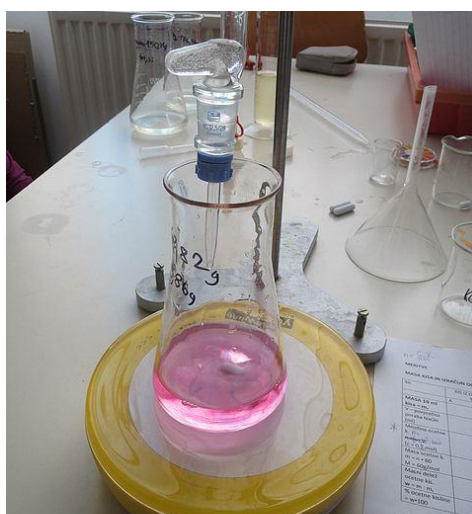
Slika 15: Spremembarve pri titraciji
