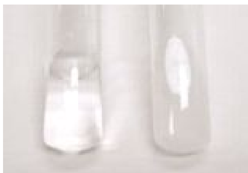
Slika 3: Karbnilno skupino dokažemo z natrijevim hidrogensulfatom(IV) \text{NaHSO}_3 . Pri tem se izloči bela oborina (desna epruveta). Leva epruveta je kontrola – voda.
