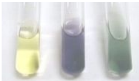
Slika 4: Dokazovanje hidroksilne skupine v fenolih z vodno raztopino železovega(III) klorida, \text{FeCl}_3 . Skrajno leva epruveta je kontrola – voda, v sredini je fenol in na desni strani je evgenol.
