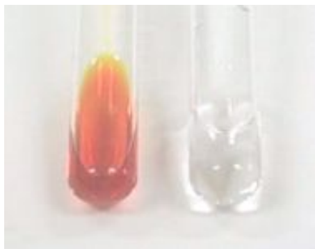
Slika 1: Raztopina broma v diklorometanu se ob prisotnosti dvojne ali trojne vezi v organski spojini razbarva. Leva epruveta je kontrola – heksan. V desni je potekla polarna adicija broma na izbran alken.
