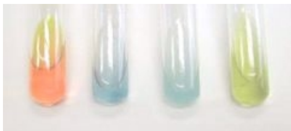
Slika 2: Od desne proti levi – oksidacija primarnega, sekundarnega in terciarnega alkohola s kislno raztopino kalijevega dikromata(VI) pri 30^{\circ}\text{C} . Skrajno leva epruveta je kontrola – voda.
