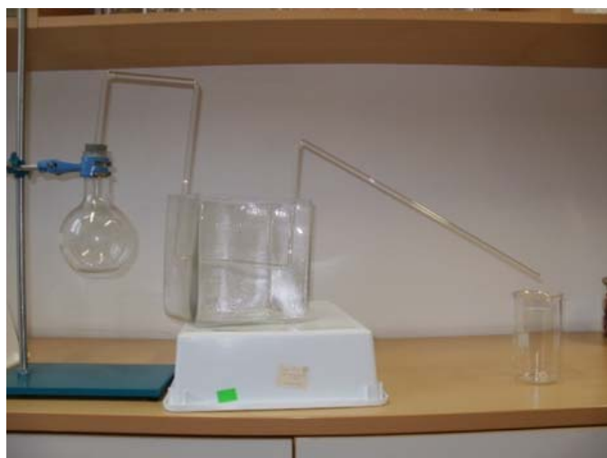
Slika 6: V šoli narejena aparatura za destilacijo.
