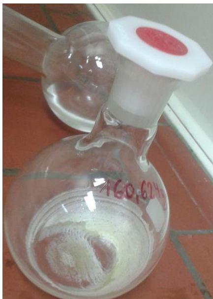
Slika 17: Destilirka s kofeinom in ločenim diklorometanom
