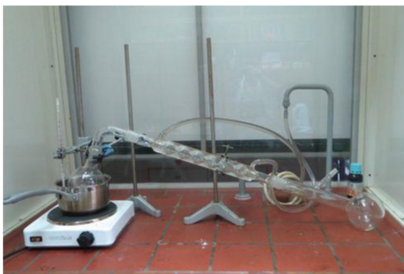
Slika 13: Celotna destilacijska aparatura
