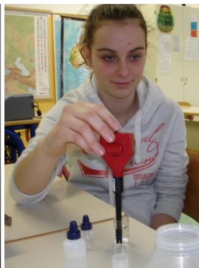
Fotografija 6: Elektronski pH Meter.
