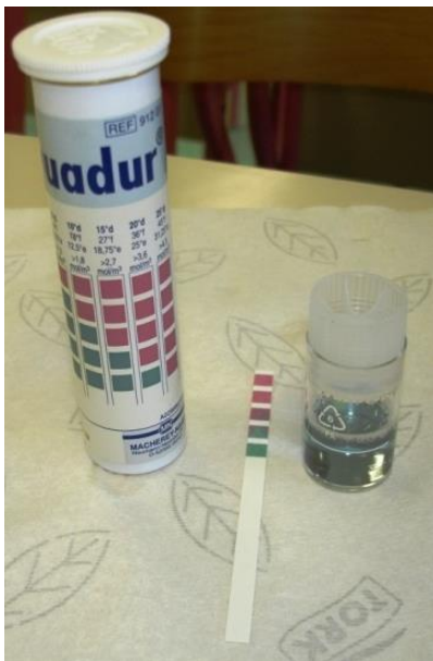
Fotografija 11: Pri ugotavljanju trdote vode so se merilni lističi pokazali točnejše vrednosti kot kapljični indikator.
