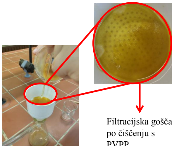
Slika 19: Nučiranje smole PVPP in nanje vezanih v vodi netopnih taninov v etanolu sox.
