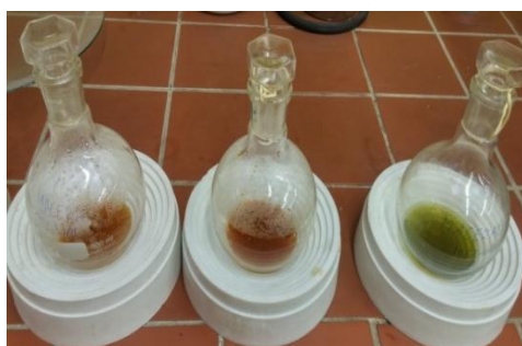
Slika 13: Vzorci maceracije po uparjanju. Od leve proti desni si sledijo etanol mac., aceton mac., metanol mac.
