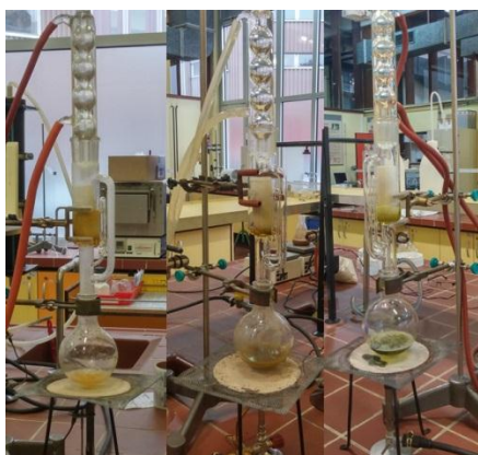
Slika 10: Ekstrakcija po Soxhletovi metodi s tremi različnimi topili. Od leve proti desni si sledijo: etanol, aceton, metanol.
