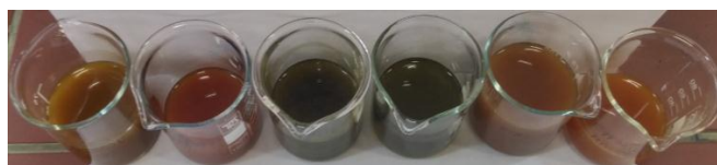
Slika 14: Ekstrakti po uparjanju. Od leve proti desni si sledijo aceton sox., aceton mac., metanol sox., metanol mac., etanol sox., etanol mac.
