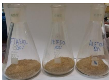
Slika 11: V jodirke zatehtamo vzorec za maceracijo. Od leve proti desni so etanol, metanol, aceton.
