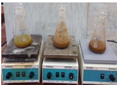
Slika 12: Maceracija z mešanjem suspenzije lubja in izbranih topil. Od leve proti desni so metanol, etanol, aceton.
