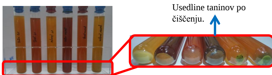
Slika 23: Vzorci po uparjanju. Iz leve proti desni si sledijo aceton sox., etanol sox., metanol sox., aceton mac., etanol mac., metanol mac.
