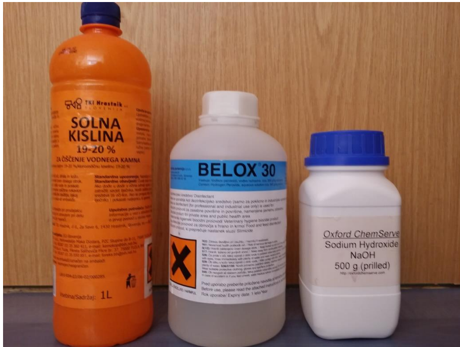
Slika 11: Kemikalije, uporabljene pri postopku jedkanja, od leve proti desni: klorovodikova kislina, vodikov peroksid, natrijev hidroksid
