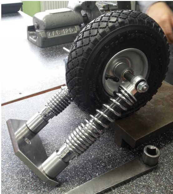
Slika 3: Vzmetenje zadnjih koles
