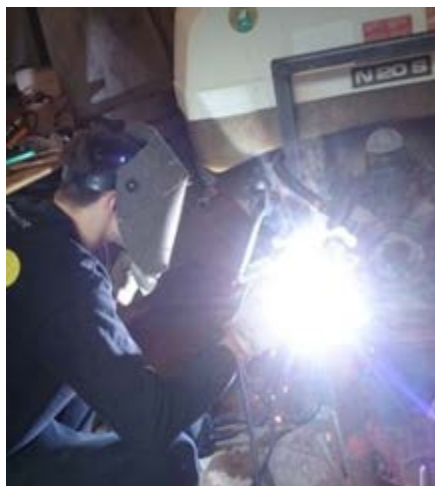
Slika 20: Varjenje nosilca na podvozje škropilnice
