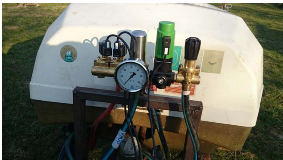
Slika 23: Priklop cevi na ventile
