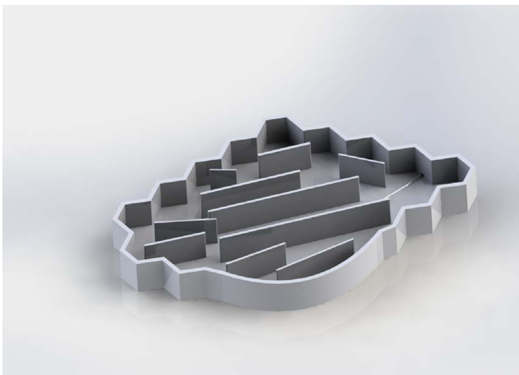
Slika 29: Rezervoar z oporami
