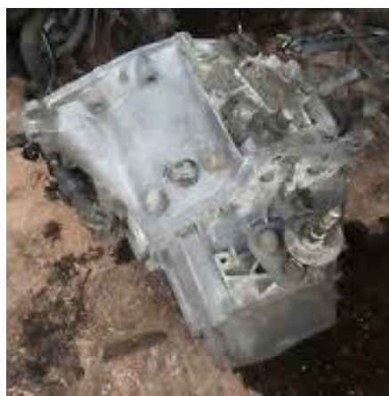
Slika 4: 5-stopenjski menjalnik peugeot
