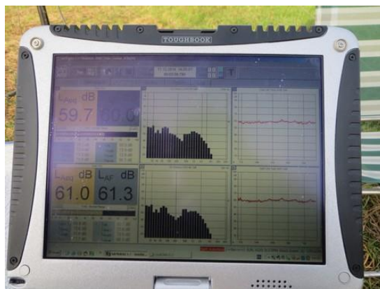
Slika 6: Merilnik hrupa je povezan z računalnikom, ki beleži podatke.
