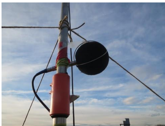
Slika 5: Merilnik hrupa je povezan z mikrofonom.
