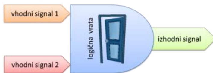
Slika 3: Logična vrata so sestavljena iz več vhodnih signalov in enega izhodnega signala
