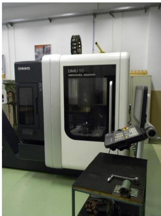
Slika 20: CNC-rezkalni stroj znamke DMG, ki se je uporabil za izdelavo čeljusti za vpetje motorja.
