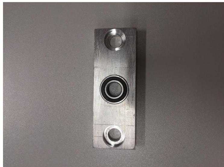
Slika 26: Prikaz zaledjenega ležaja v ohišje
