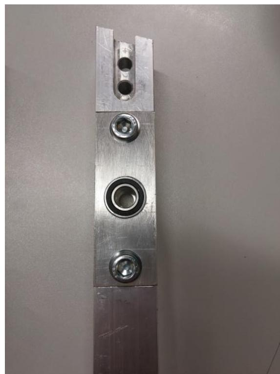
Slika 27: Roka z ležajem in ploščica z ležajem.
