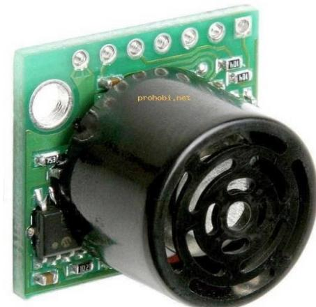
Slika 33: Ultrazvočni senzor
