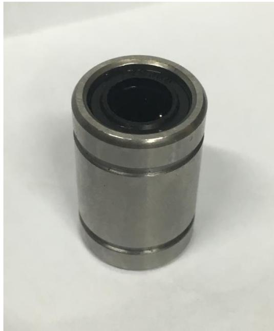
Slika 12: Ležaj za drsne palice (lastni vir)
