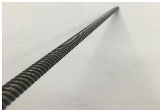
Slika 18: Palica s trapeznim navojem (lastni vir)
