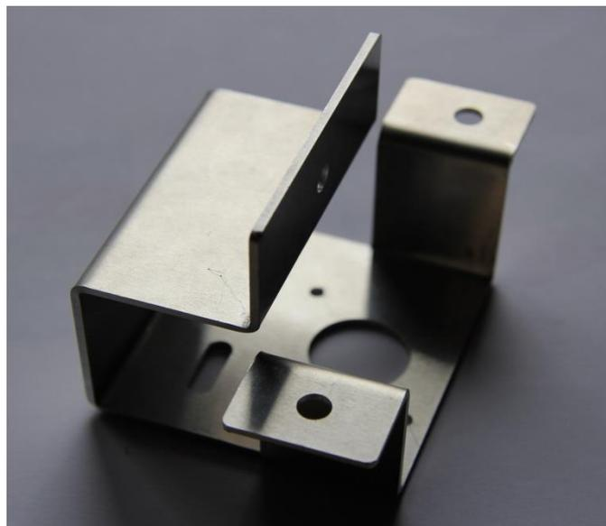
Slika 14: Izdelani nosilec za motorčke (lastni vir)
