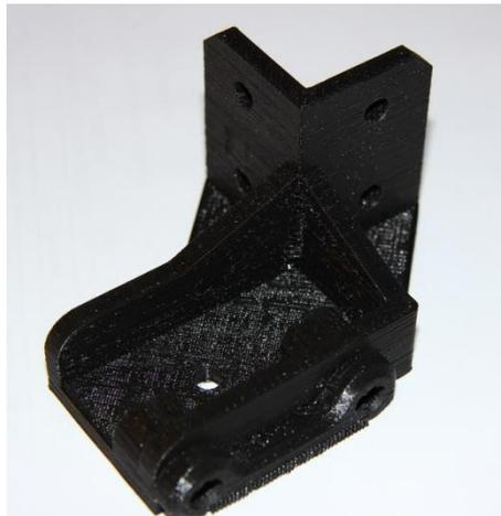
Slika 20: Natiskani model zgornjega nosilca za palice (lastni vir)
