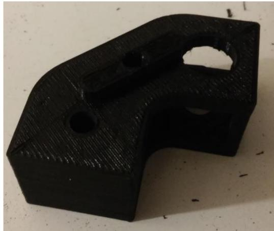
Slika 10: Natiskani nosilec za navojne in drsne palice (lastni vir)
