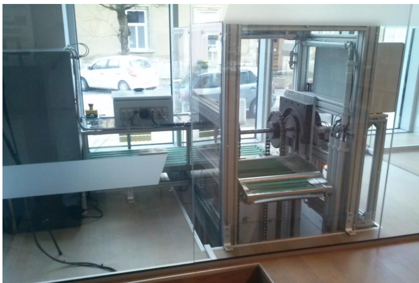
Slika št. 28: Avtomatizirani sistem prenosa knjige
