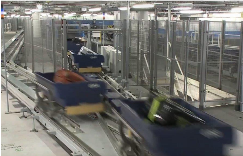
Slika št. 30: Avtomatizirano gibanje vozičkov za letališke prtljage
