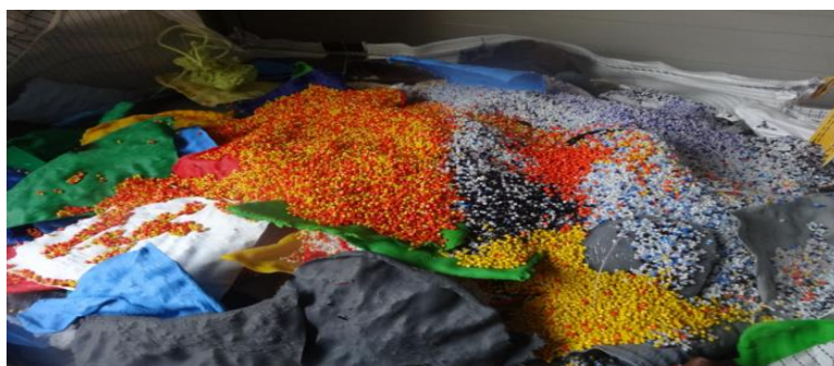
Slika 18: Pri izdelavi masterbatchov in platen nastane veliko odpadnega materiala, ki ga nato reciklirajo.
