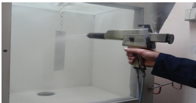
Slika 17: S pištolo na kovinske ploščice nanašajo praškast lak, v katerem so drobno zmleti delci pigmenta in smole.
