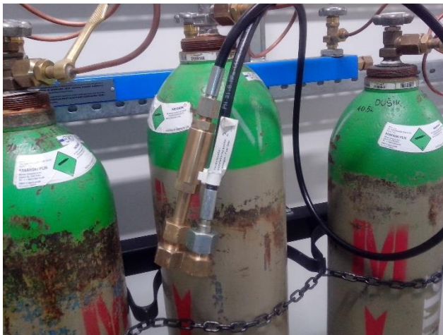
Slika 21: Plinske jeklenke z etilenom – zorilni plin (Foto: Koren, 2015)
