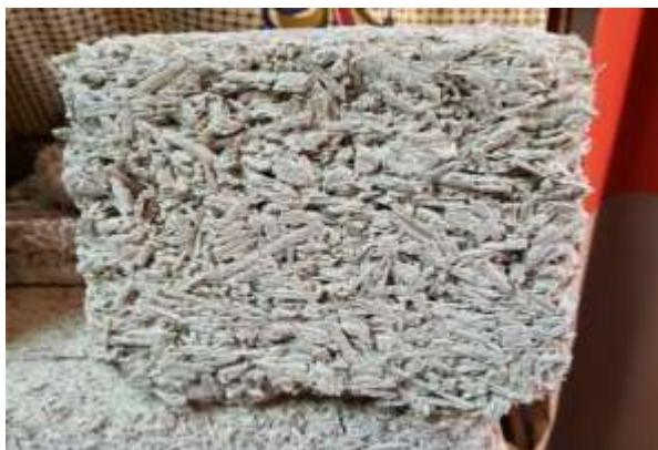
Slika 36: Blok iz konopljinega betona (brez dodatka cementa)
