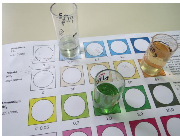
Slika 6: Ocenjevanje koncentracije fosfatnih, nitratnih in amonijevih ionov s pomočjo obarvanja vzorca po dodatku ustreznih reagentov.
