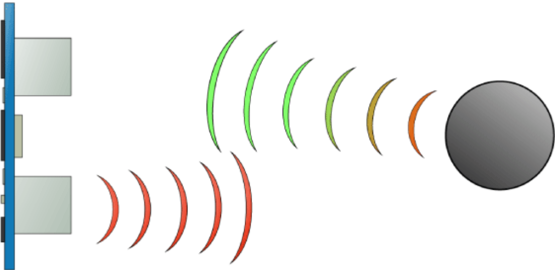
Slika 13: Princip delovanja ultrazvočnega senzorja
