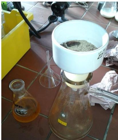
Slika 11: Filtracija pod znižanim tlakom. (Lasten vir)
