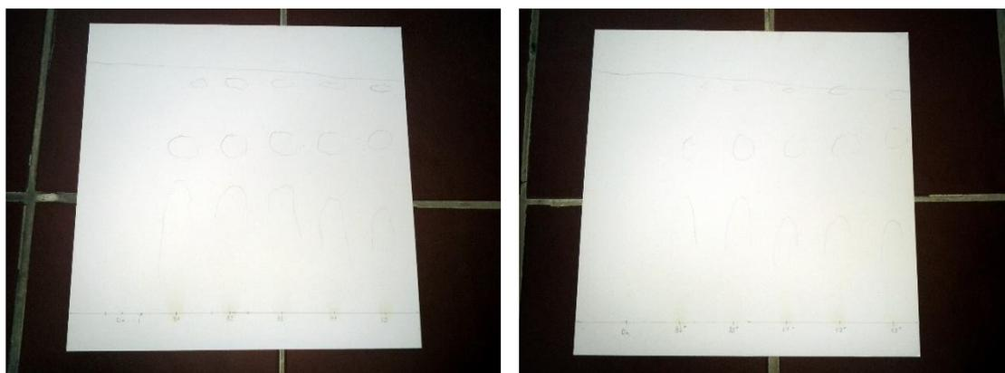
Slika 27: Kromatograma št. 7 in 8 z nanešenim standardom in heksanovimi fazami. (Lasten vir)
