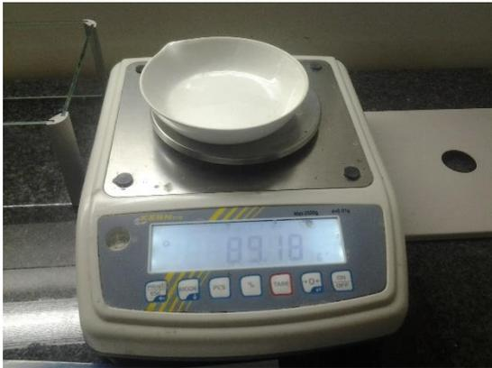
Slika 15: Zatehtanje izparilnice. (Lasten vir)
