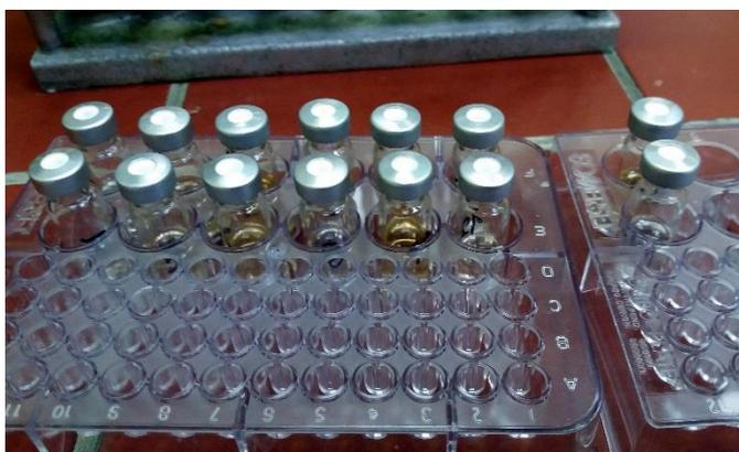
Slika 35: Vzorca v vialah, pripravljene za plinski kromatograf. (Lasten vir)
