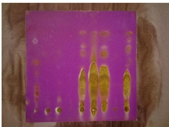
*Slika 21: Kromatogram št. 1 pri identifikaciji s škropljenjem z raztopino  $\text{KMnO}_4$ . (Lasten vir)*
