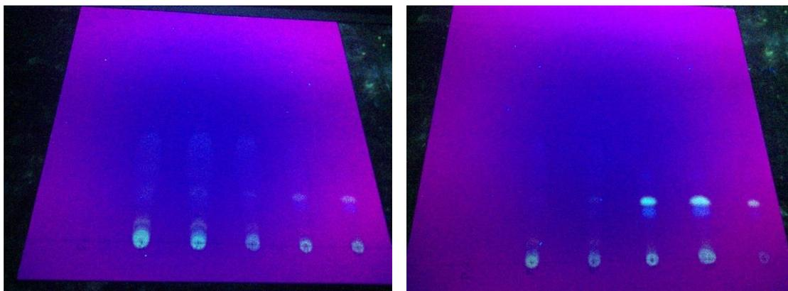
Slika 28: Kromatograma št. 7 in 8 pri identifikaciji pod UV lučjo valovne dolžine 254 nm. (Lasten vir)
