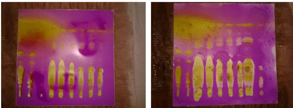
Slika 34: Kromatograma št. 9 in 10 pri identifikaciji s škropljenjem z raztopino  $KMnO_4$ . (Lasten vir)
