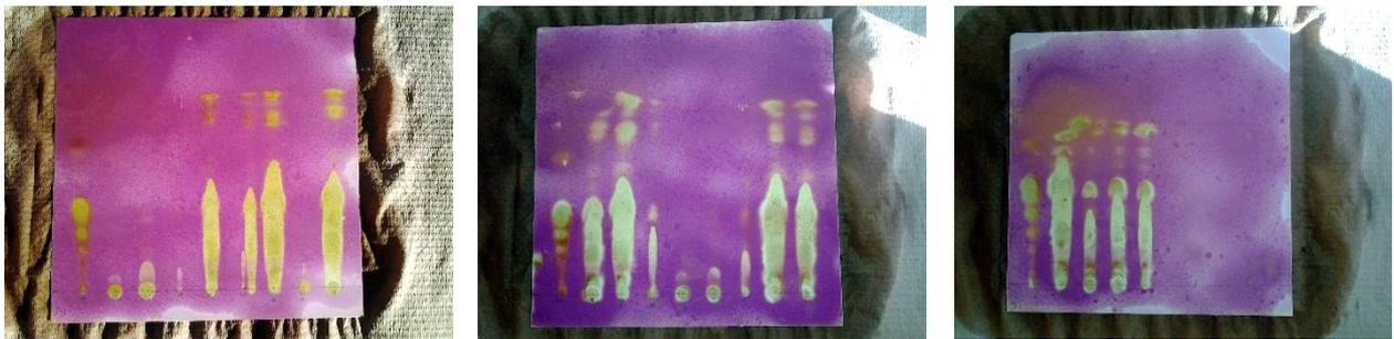
Slika 25: Kromatogrami št. 4, 5 in 6 pri identifikaciji s škropljenjem z raztopino  $KMnO_4$ . (Lasten vir)
