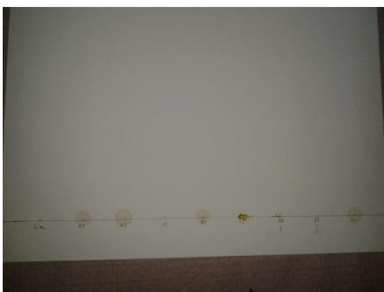
*Slika 20: Kromatogram št. 1 z nanešenim nečistim limonenom in vzorci. (Lasten vir)*
