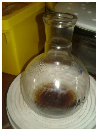
Slika 14: Ekstrakt po uparevanju z rotavaporjem. (Lasten vir)
