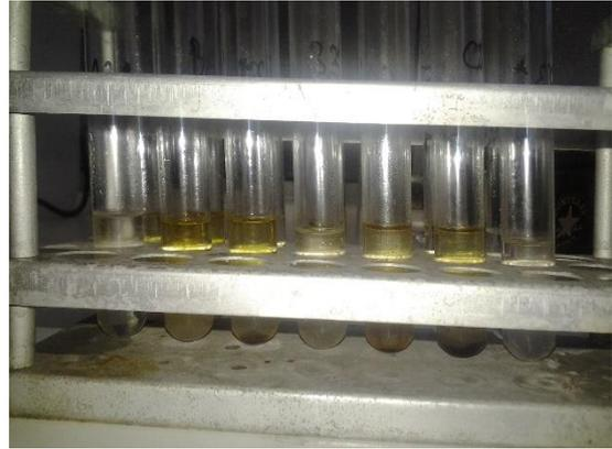
*Slika 31: Vzorci, namenjeni za GC analizo po stresanju s heksanom in vodo. (Lasten vir)*
