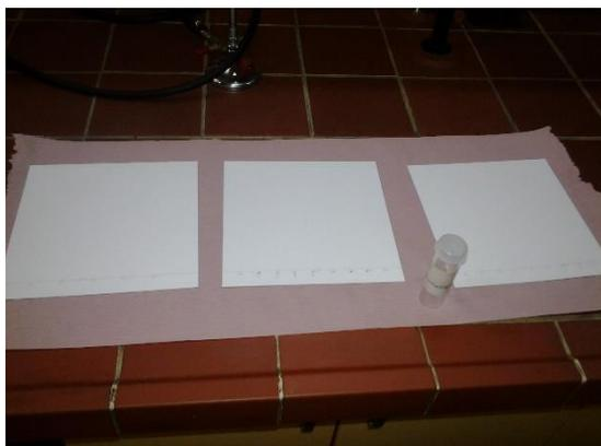
*Slika 17: Priprava kromatografskih plošč.
