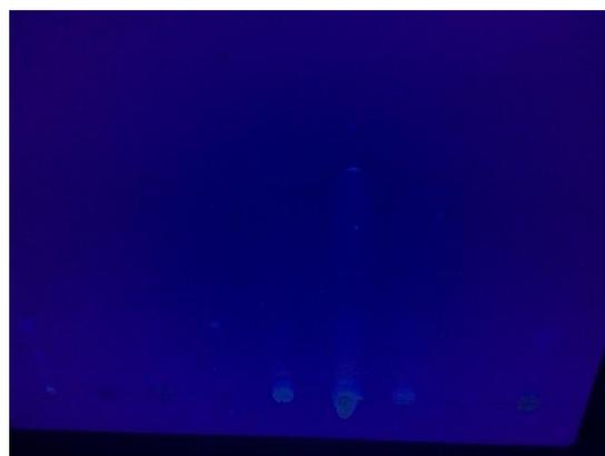
*Slika 22: Kromatogram št. 1 pri identifikaciji pod UV lučjo valovne dolžine 254 nm. (Lasten vir)*
