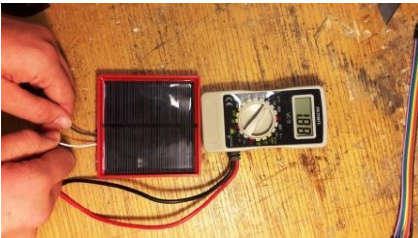
Fotografija 4: Z ampermetrom smo preverili, koliko energije oddaja posamezni modul.
