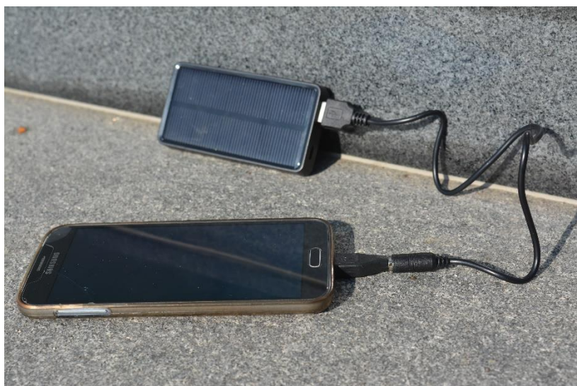
Fotografija 12 : Solarni polnilec VOLT CRAFT na Soncu v položaju, da sončni žarki vpadajo na sončne celice neposredno.
