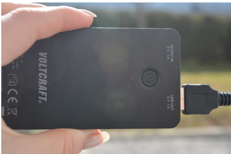
Fotografija 13: Kadar na solarnem polnilcu gori rdeča lučka, pomeni da se polnilec uspešno polni na sončno energijo.
