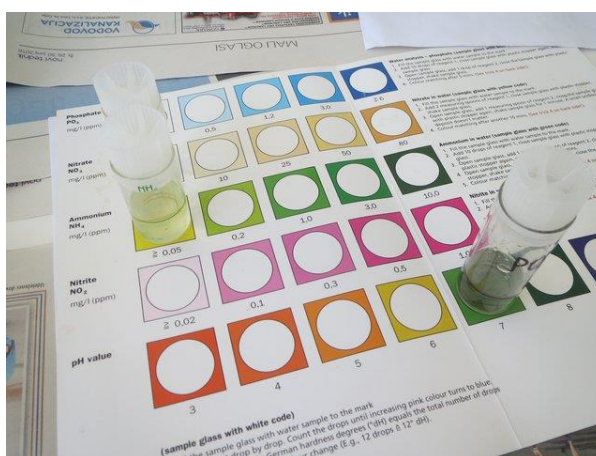
Slika 18: Ocenjene vrednosti masnih koncentracij amonijevih kationov, nitratnih anionov in pH v vodi, odvzeti iz zgornjega toka Lahovškega potoka.
