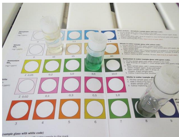
Slika 19: Ocenjene vrednosti masnih koncentracij amonijevih kationov, nitratnih anionov in pH v vodi, odvzeti iz spodnjega toka Lahovškega potoka.
