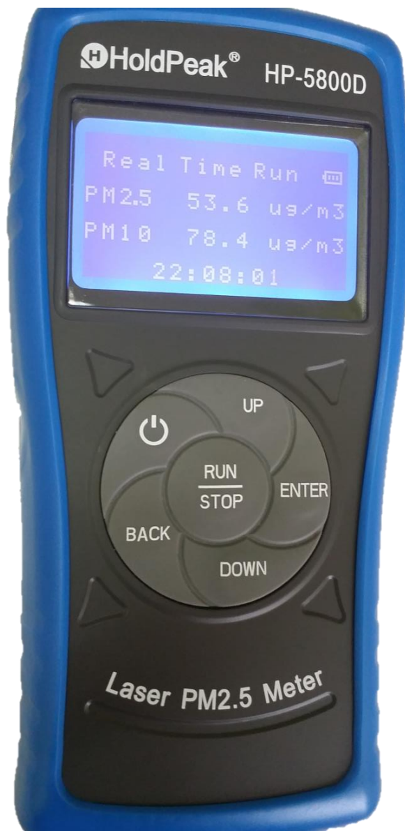
Slika 8: Digitalni laserski merilnik prašnih trdnih delcev PM 10 in PM 2,5
