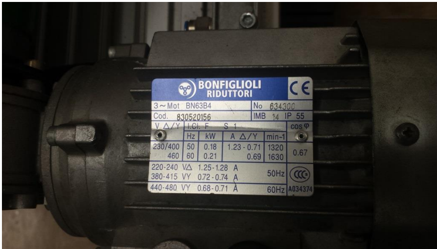
Slika 9: Pogon velikega tekočega traku
