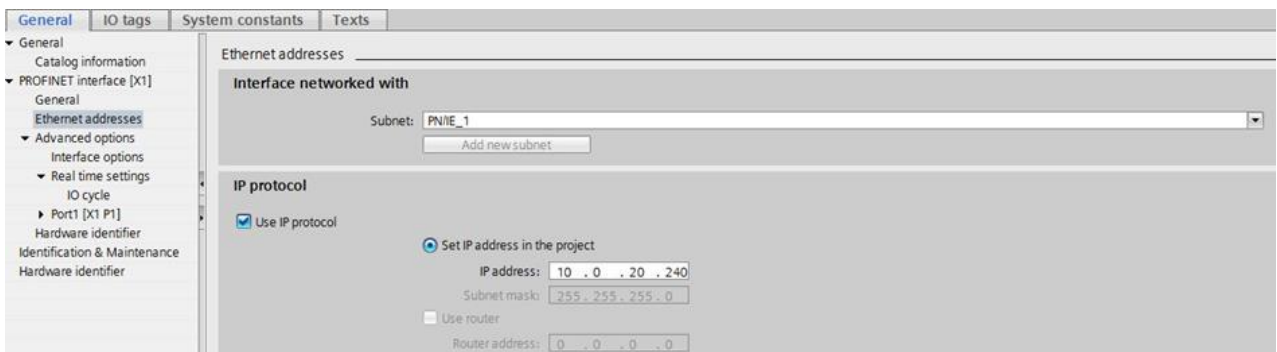
Slika 23: Nastavitev KRC4 v TIA-Portalu (Osebni vir)
