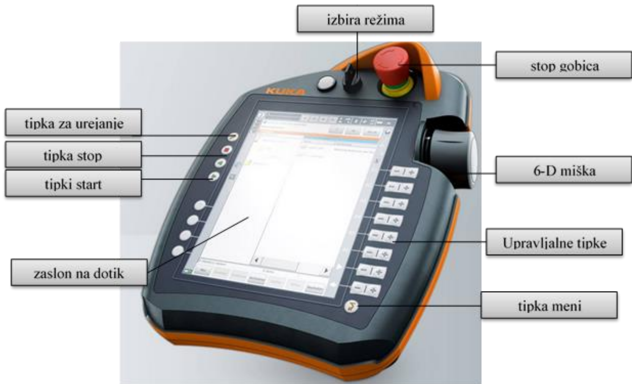
Slika 15: Kuka KCP teach pendant
