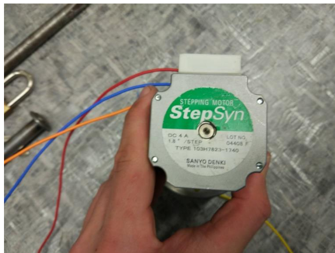
Slika 29: Zadnji del koračnega elektromotorja s specifikacijami
