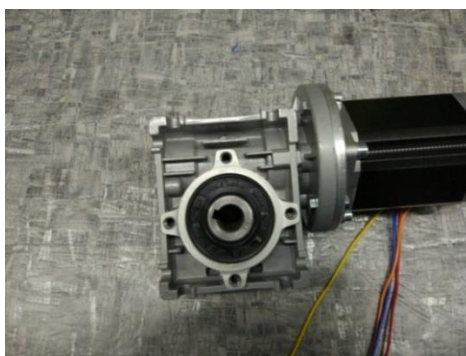
Slika 35: Motor, nameščen na polžasto gonilo
