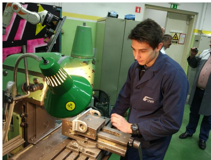
Slika 16: Frezanje robov pregibnega elementa
