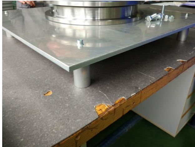
Slika 37: Valjasti podstavki, nameščeni na kote podnožne plošče
