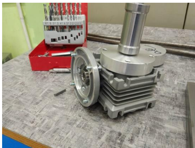
Slika 33: Sestava osi, vmesnega elementa in gonila
