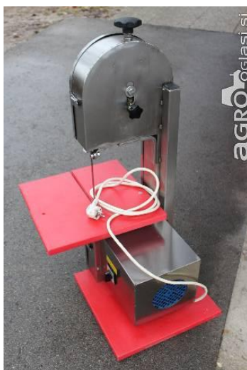
Slika 4: Žaga iz INOX profilov Vir: slikovni vir 3
