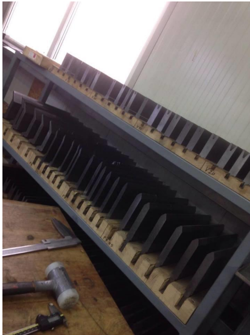
Slika 28: Noži in prizme za krivilni stroj Vir: osebni arhiv
