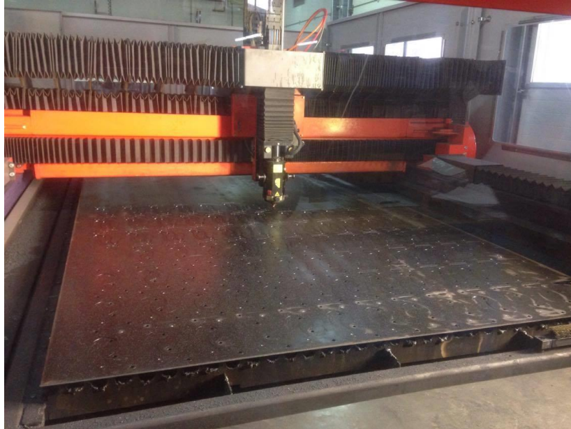
Slika 19: Laserski razrez v podjetju Vija, d. o. o. Vir: osebni arhiv
