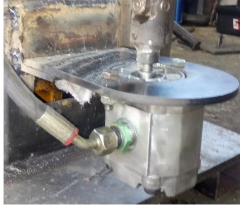
Slika 7: Pritrditev in pogon črpalke
