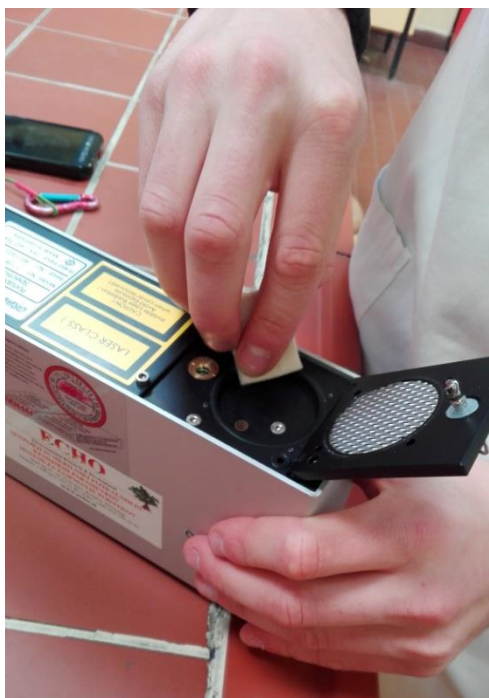
Slika 25: Čiščenje filtrirne komore
