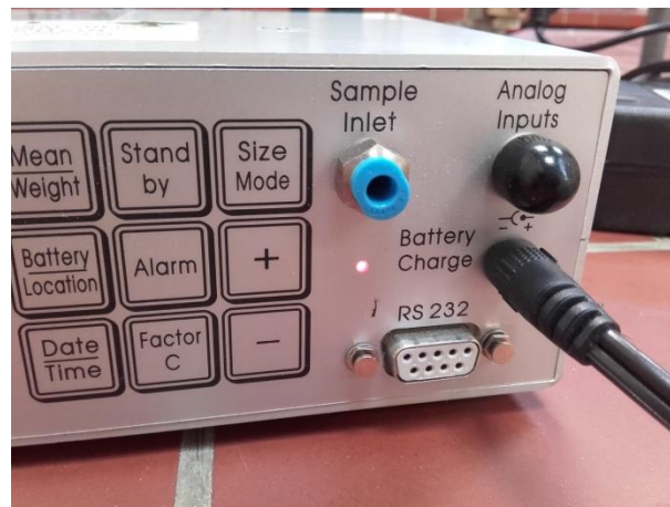
Slika 22: Polnjenje GRIMM-a; prikaz indikatorske lučke ob polnjenju baterije
