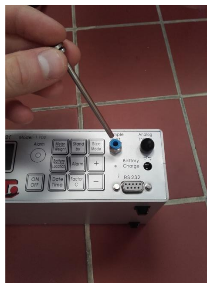
Slika 26: Vstavljanje filtrirne cevke
