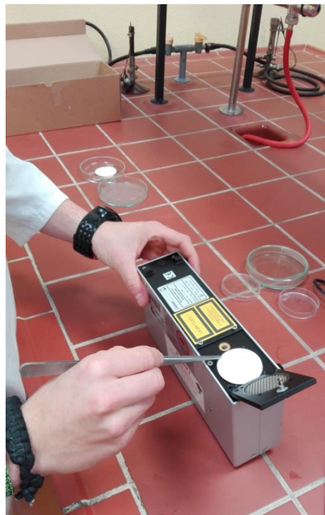
Slika 24: Vstavljanje filtra v filtrirno komoro
