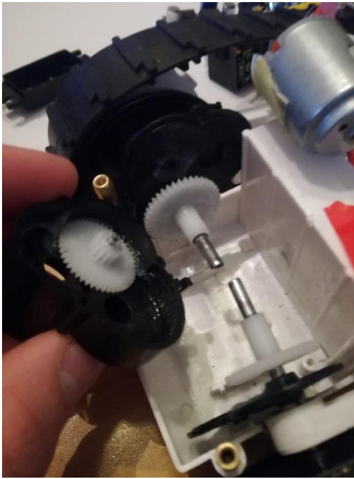
Slika 17 Prvi motorji in njihova zgradba
