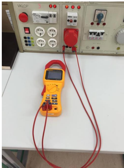
Slika 55: Priključitev Fluke 345 na prvo fazo.
