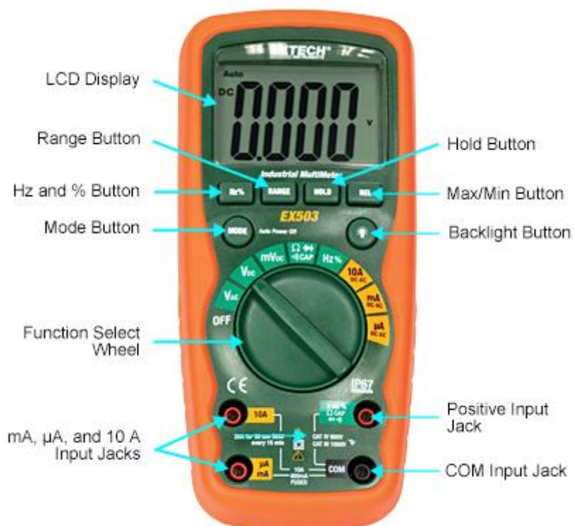
Slika 3: Merilna digitalna naprava z opisi sestavnih delov.
