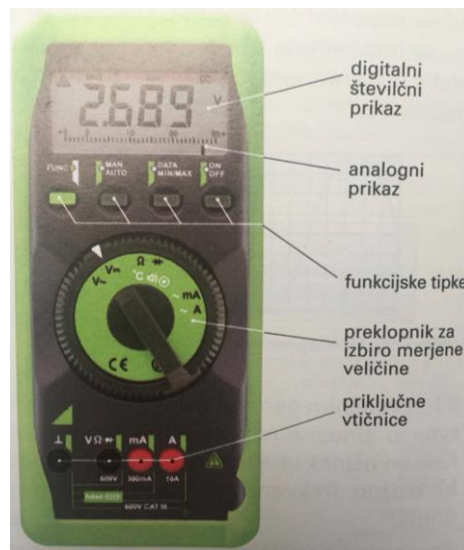
Slika 1: Merilna digitalna naprava z opisi sestavnih delov.
