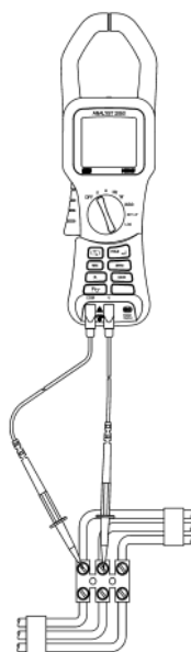
Slika 20: Merjenje napetosti z merilnikom Fluke 345.
