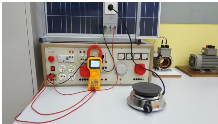
Slika 25: Merjenje moči z merilnikom Fluke 345 v laboratoriju.
