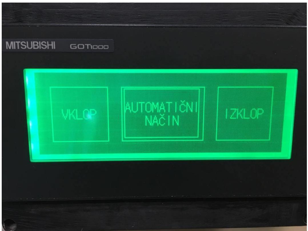
Slika 7: Ročni vklop ali izklop motorja za dvig ali spust kupole
