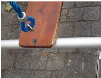
43. Glavni trg - zlomljen vijak na pripravi
