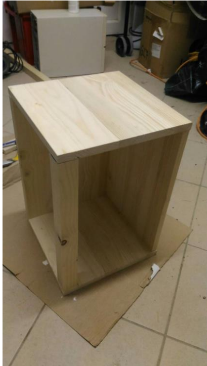
Slika 4.21: Lepljenje ohišja cajona
