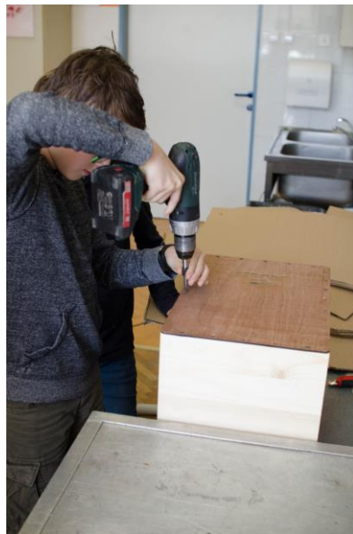
Slika 4.24: Privijanje tape na ohišje
