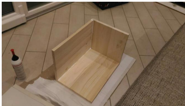
Slika 4.20: Lepljenje ohišja cajona
