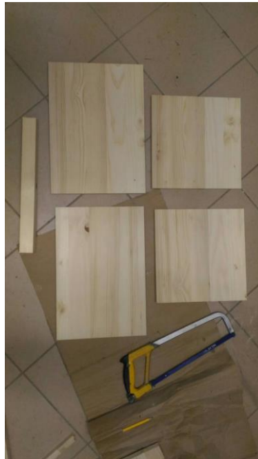
Slika 4.19: Plošče, razvrščene za izdelavo ohišja cajona
