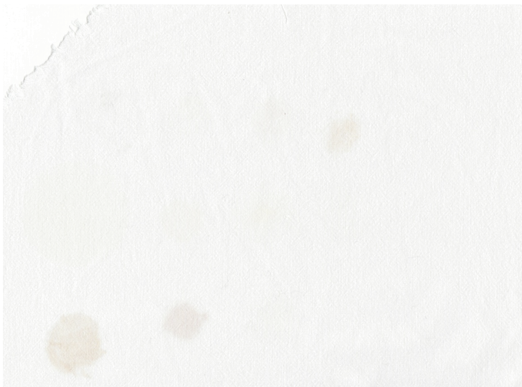
Slika 4: Krpa, oprana z detergentom Persil iz Švice, temperatura pranja: 95°C
