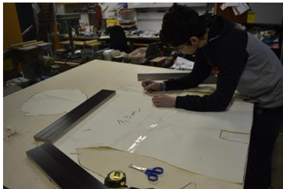
Slika 8: Obrisovanje trupa na vezani plošči
