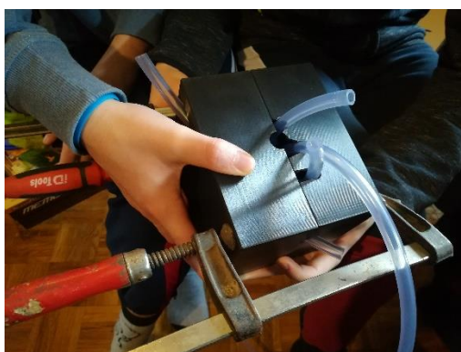
Slika 18: Kalupa pripravljena za vlivanje (Vir: Valentin Gartner in Miha Ocvirk)
