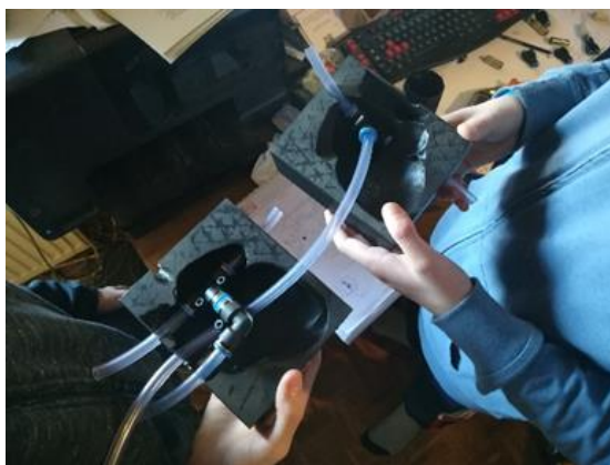
Slika 17: V kalup vstavljeni priključki. (Vir: Valentin Gartner in Miha Ocvirk)
