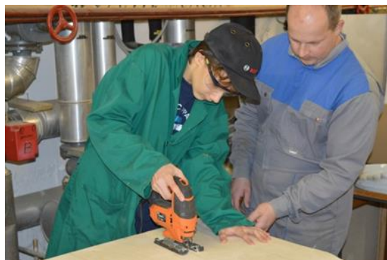
Slika 10: Pri delu z obodno žago je potrebno paziti na naklon in na prste.
