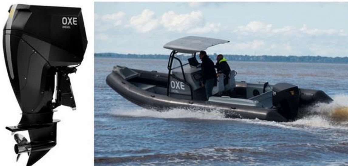
Slika 5: Cimco 200 OXE – prvi serijski dizelski izvenkrmni motor [9]
