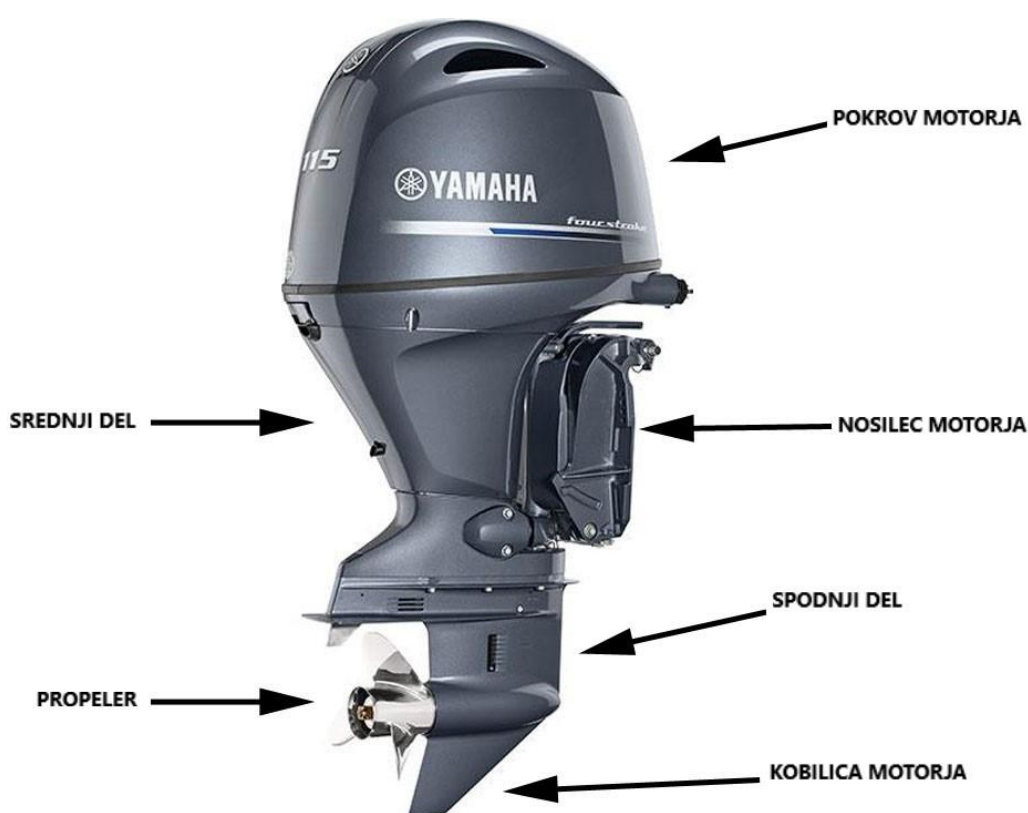
Slika 2: Zgradba izvenkrmnega motorja [27]
