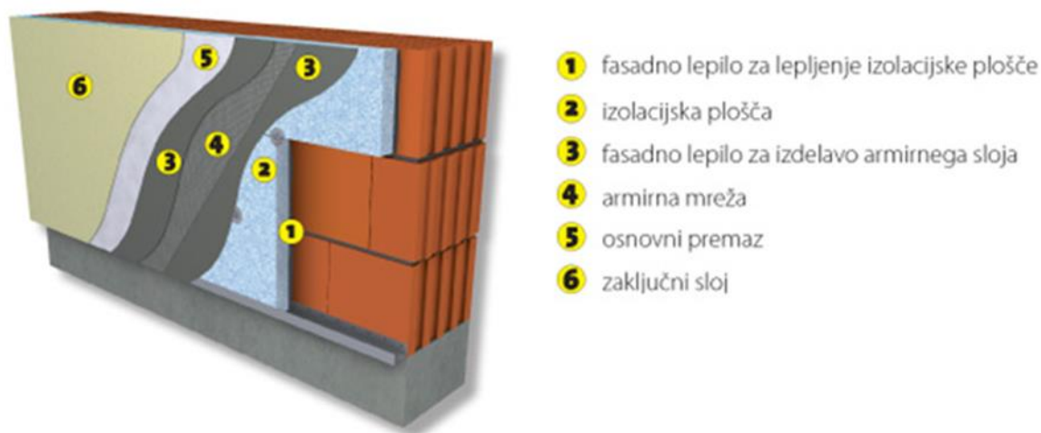
Slika 8: Sestava fasadnega sistema [18.]
