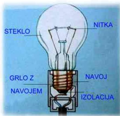
Slika 14: Klasična žarnica z žarilno nitko [4.]
