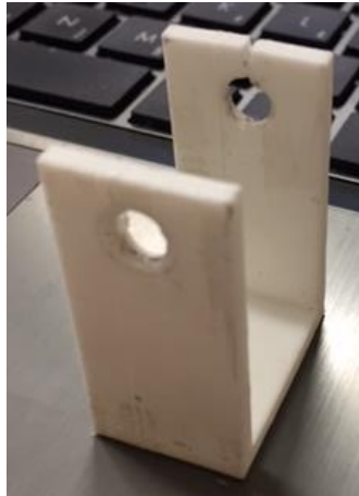
Slika 6: "Končni 3D-print nosilca gredi prototipa v2.0" (Osebni vir)
