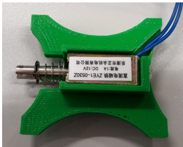
Slika 29: "Končna fizična oblika nosilca solenoida" (Osebni vir)
