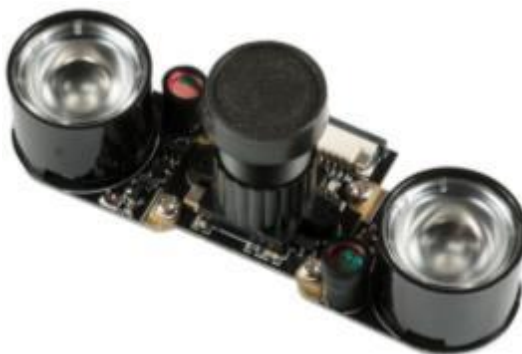
Slika 3-40: Kamera z nočnim vidom in nastavljivo lečo [18]
